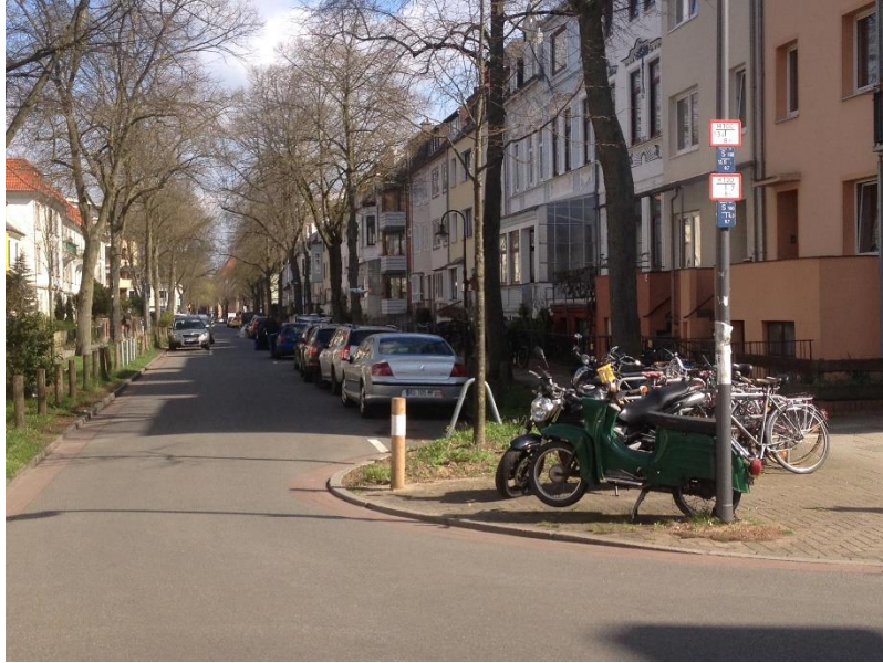
Figura 59. Exemplu pentru amenajare însăși explicită de pe o strada rezidențială cu circulație atenuată din Bremen
